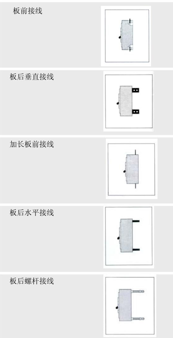
图 1-5 断路器主电路联结方式
