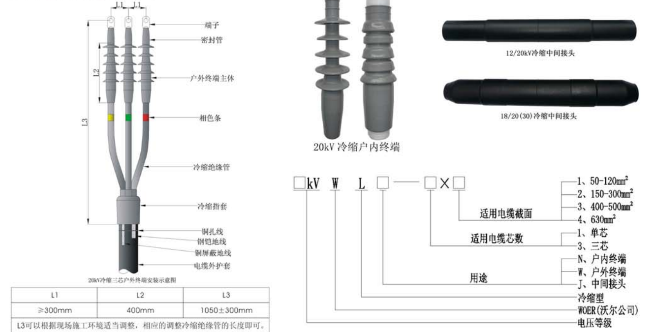
20kV电缆附件主要试验参数及规格划分
